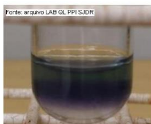
Figura 5 – Teste Duquenois - Levine positivo para amostra de maconha. (CAMARGOS, 2018, p. 11).
