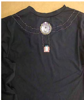
Figura 6 – Microprocessador e bluetooth aplicados na blusa.
