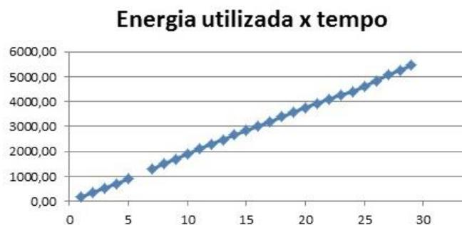
Figura 4: Energia elétrica utilizada na eletrólise da água. No minuto 6, ocorreu um erro na transmissão da medida do Arduino para a planilha eletrônica, por esta razão o valor está faltando.
