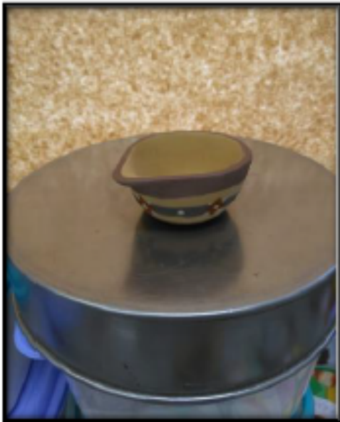
Vaso cerâmico pintado com as tintas do tipo acrílica (resíduo mineral C2, argila vermelha e bege clara).
