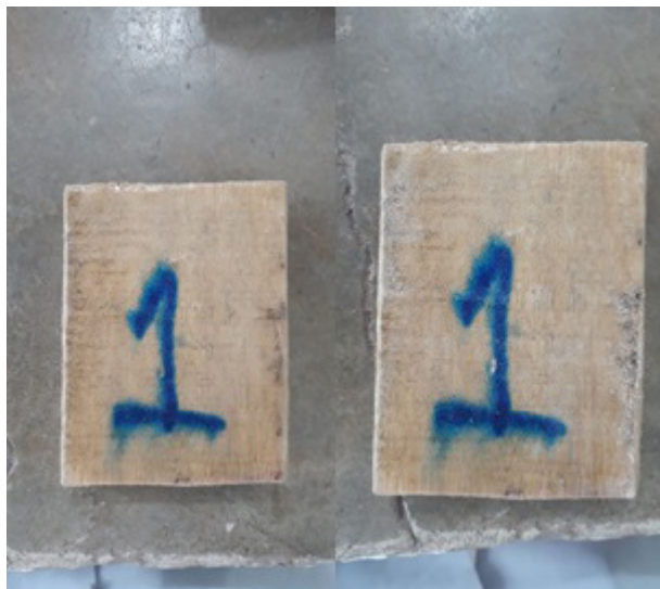
Figura 1 – Antes e depois da amostra após abrasão com a lixa 60
