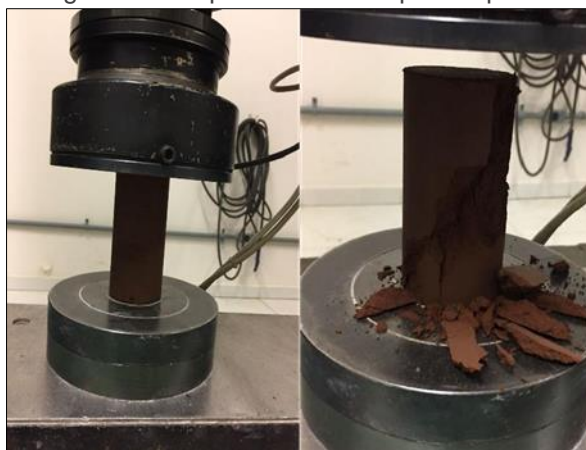
Figura 3: Rompimento dos corpos de prova.
