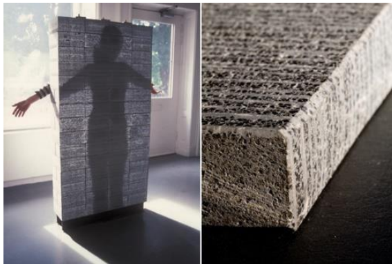
Figura 2: Concreto Transmissor de Luz
