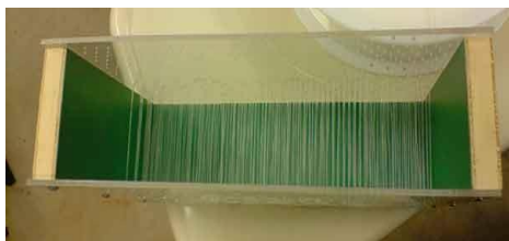
Figura 5: Fibras ópticas posicionadas na fôrma
