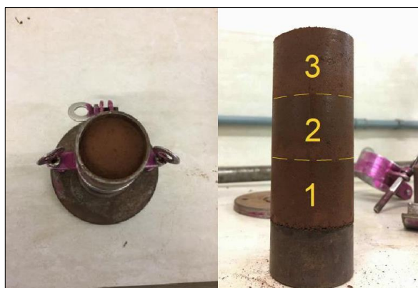
Figura 2: Molde utilizado para corpo de prova compactado com a identificação das camadas.
