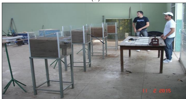
Figura 1: Bancada montada para o experimento: Colunas de solo representando as unidades experimentais (a), direção da frente de avanço do bulbo úmido a partir do ponto de emissão do gotejador (b).
