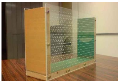
Figura 4: Fôrma usada para a fabricação do bloco de concreto translúcido
