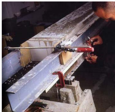
Figura 3: Molde concreto com fibra óptica
