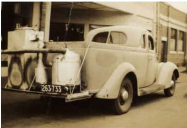
Figura 8 - Gaseificador Imbert e veículo acionado por gás de biomassa. (ANDRADE, 2007).
