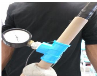
Figura 14 - Manômetro posicionado logo antes do tubo de fixação do foguete – autoria própria
