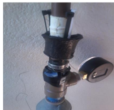
Figura 16 - Presilhas fixadas por abraçadeira de metal com ponta a 1m acima do gargalo do foguete
