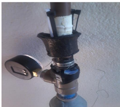
Figura 4 – Gatilho feito de couro ou PVC 40mm usado para travar o foguete quando ele pressiona as presilhas. Autoria própria
