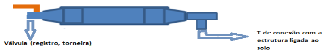
Figura 5 - Reservatório com fixação de válvula
