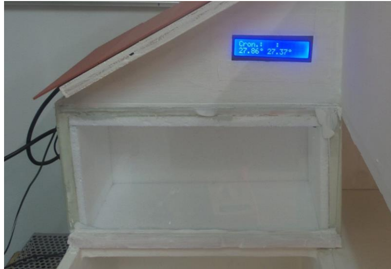
Figura 31 – Visor que apresenta os valores de temperatura medidos pelos sensores e o cronômetro.
