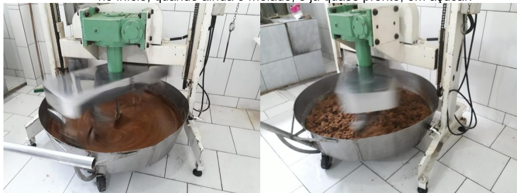
Figura 3 – Máquina que bate o melado transformando-o em açúcar, em duas etapas: no início, quando ainda é melado, e já quase pronto, em açúcar.
