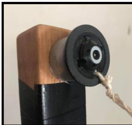
FIGURA 21 - MOTOR COLADO NA HASTE
