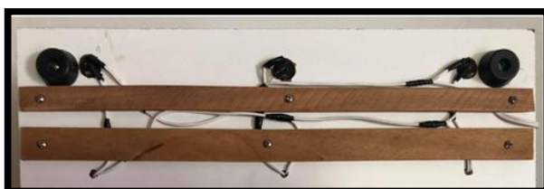
FIGURA 4 - PROTEÇÃO PARA OS FIOS
