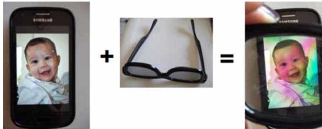
Figura 89 - Alteração na cor da luz emitida pela tela do celular quando os óculos polarizadores são girados na sua frente.
