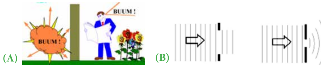
Figura 73 - ilustrações de situações onde ocorre difração (A) o som ao incidir no muro, (B) ondas na superfície da água e (C) ondas de rádio AM chegando a uma antena receptora atrás de um obstáculo.
