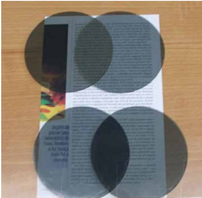
Figura 90 - e as lentes forem combinadas de forma que fiquem com polarizações opostas a luz pode ser impedida de passar.
