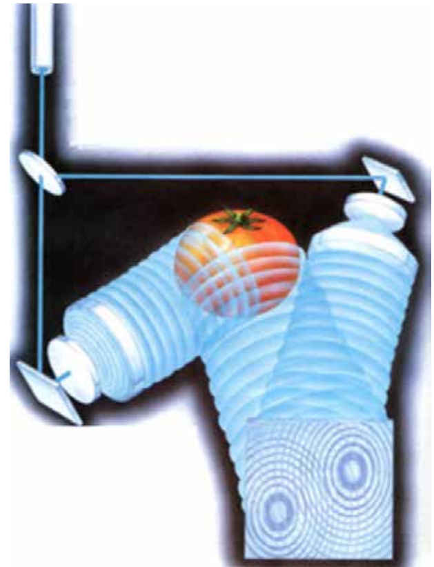
Figura 97 - Criação do registro holográfico.
