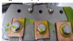
Sapata coletora e pontos de conexão.
