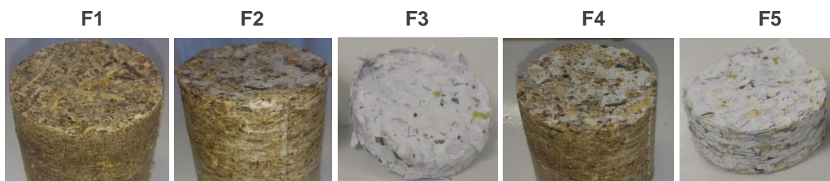
Figura 4. Briquetes produzidos correspondendo a cada formulação.
