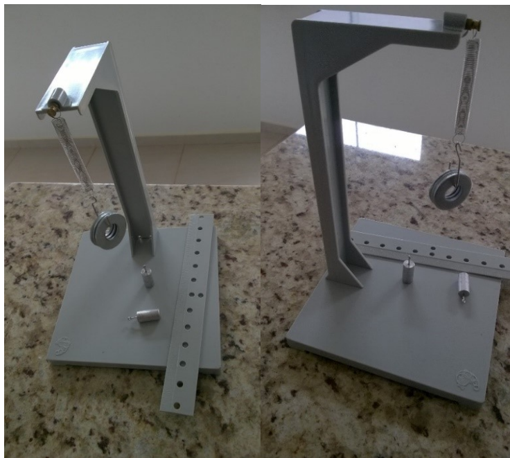
Figura 8: Sistema massa mola elaborado pela SBF. Fonte: autor do texto.
