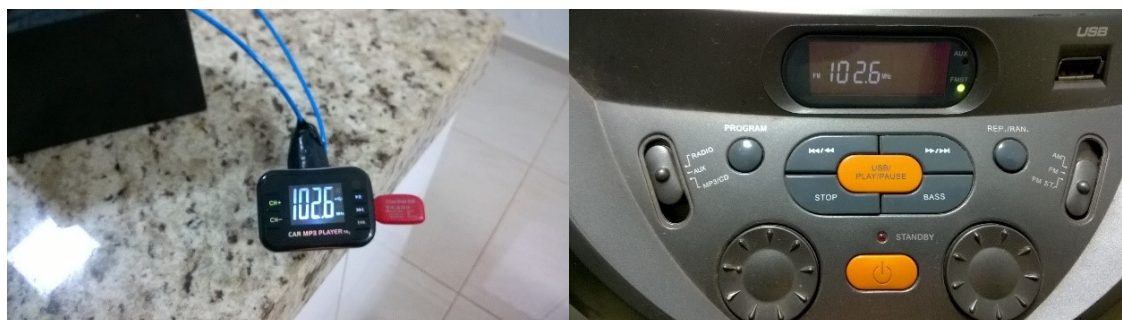
Figura 16 e 17: repetidor FM emitindo em 102,6 MHz e rádio (aparelho) sintonizado na frequência do repetidor.
