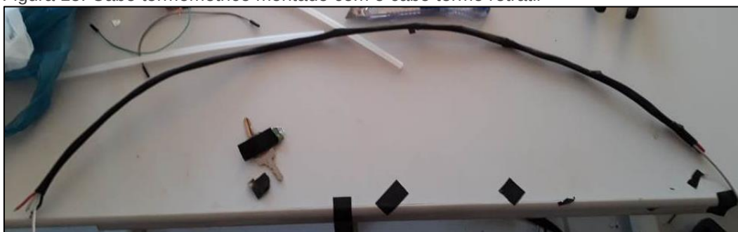
Figura 15. Cabo termométrico montado com o cabo termo retrátil
