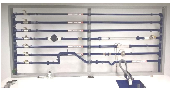
Figura 1 - Bancada de estudos de fenômenos de transporte.
