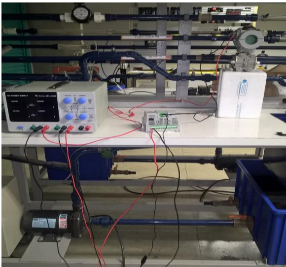
Figura 6 - Teste com CLP e transmissor.
