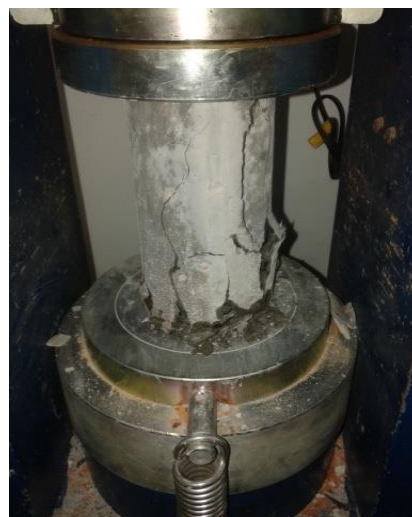
Figura 06 - Corpo de prova sendo comprimido.
