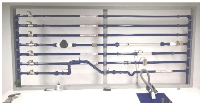
Figura 1 - Bancada de estudos de fenômenos de transporte.
