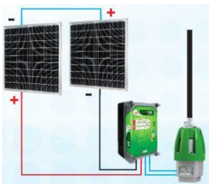
Figura 01 - Componentes principais de um sistema de bombeamento fotovoltaico. Os módulos solares são de 85 Wp e tensão de 17 volts cada, ligados em série.
