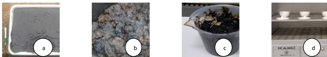
Figura 1. Lodo Agroindustrial do Matopiba (TO): a) secagem do lodo com energia solar; b) secagem do lodo em estufa; c) lodo seco (oleoso) a peso constante; d) lodo na estufa pronto para análises.
