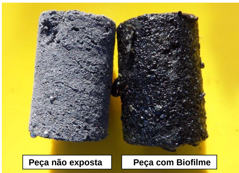
Figura 10 - Corpos de prova sem deposição e com deposição de biofilme.
