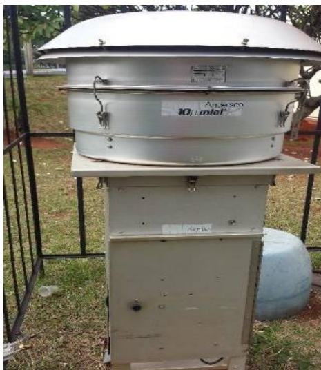
Figura 03 – AVG-MP 10 . No local instalado.
