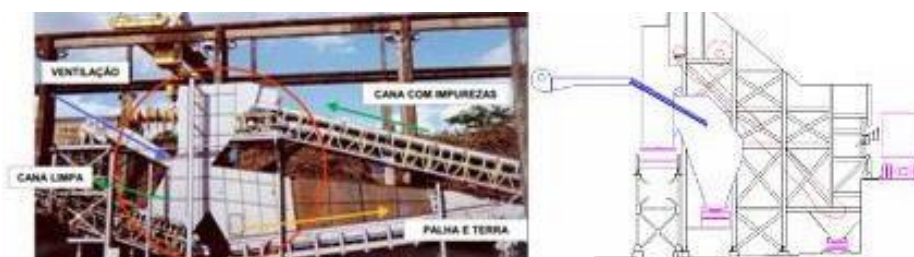
Figura 04: Sistema de limpeza a seco cana-de-açúcar
