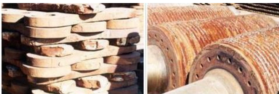
Figura 06: Ilustração dos desgastes dos martelos do desfibrador e dos rolos de moenda
