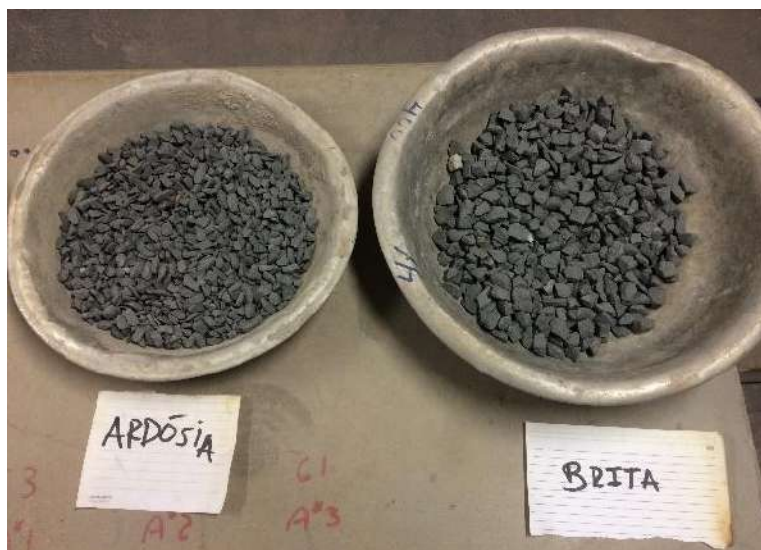
Figura 01: Agregados graúdos separados conforme a granulometria.
