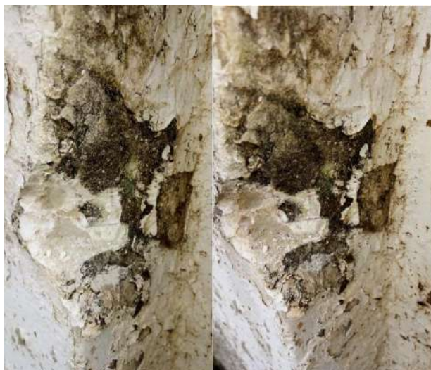
Figura 13 – P50 antes da aplicação da fenolftaleína (esquerda) e após aplicação (direita).
