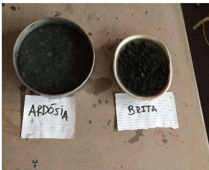
Figura 2: Processo de saturação dos agregados graúdos.
