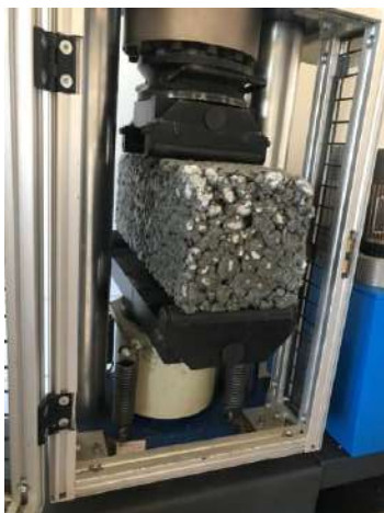
Figura 011- Ensaio de tração em andamento.
