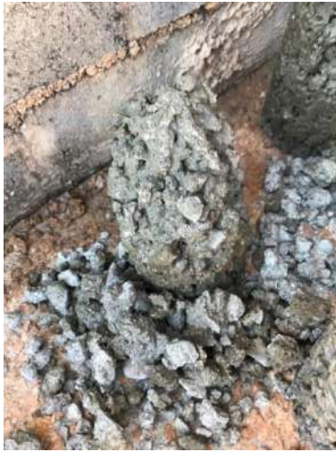
Figura 012- Traço P2C ao ser desmoldado.
