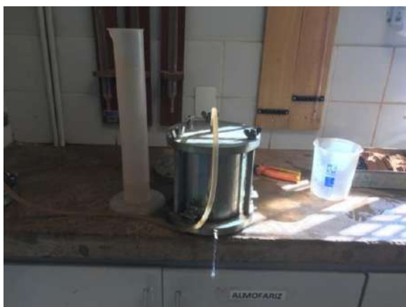
Figura 015 - Ensaio de permeabilidade em andamento
