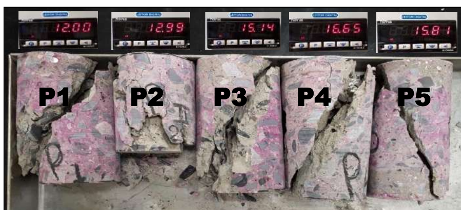
Figura 18: Detalhe do formato de ruptura e da força aplicada (em toneladas) nos testemunhos.
