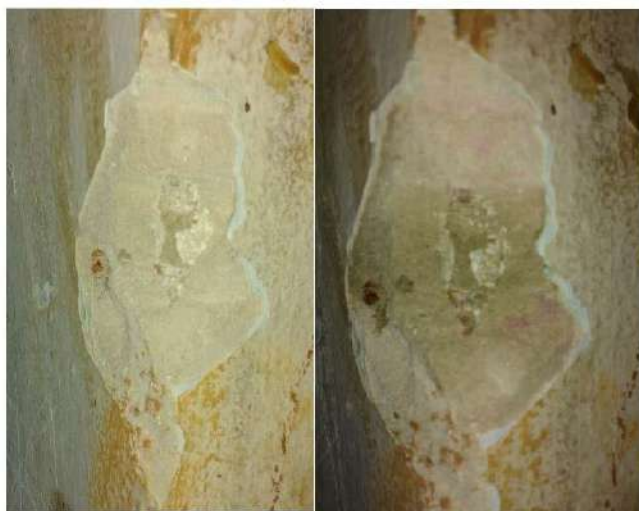
Figura 12 – P14 antes da aplicação da fenolftaleína (esquerda) e após aplicação (direita).
