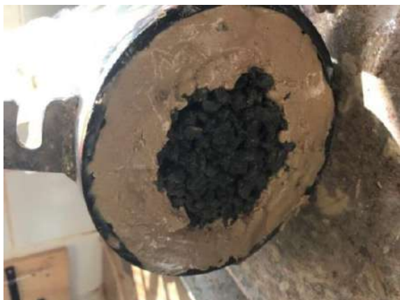
Figura 014- Revestimento do equipamento com bentonita.
