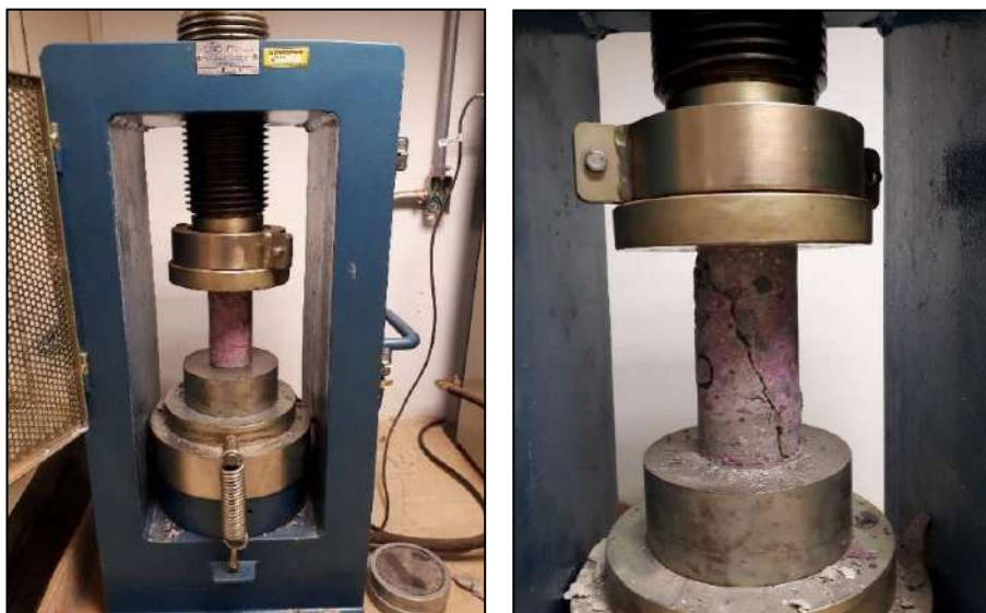
Figura 17: Detalhe do ensaio de resistência à compressão do concreto dos testemunhos.
