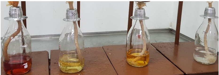
Figura 12: Lamparinas artesanais com óleo de diesel de petróleo, biodiesel, gasolina e etanol (nessa ordem da esquerda para a direita)
