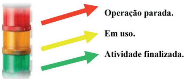
Figura 2 – Configuração da iluminação do sistema Andon
