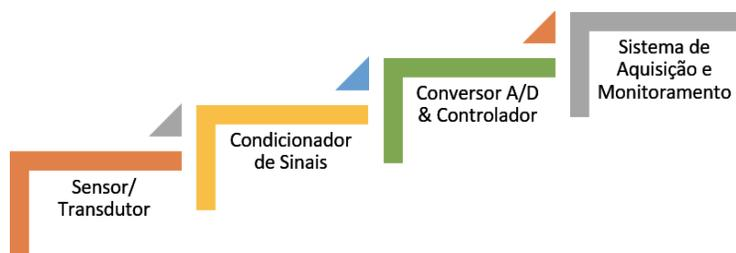
Figura 2.1. Estrutura do Sistema de Aquisição de Dados
