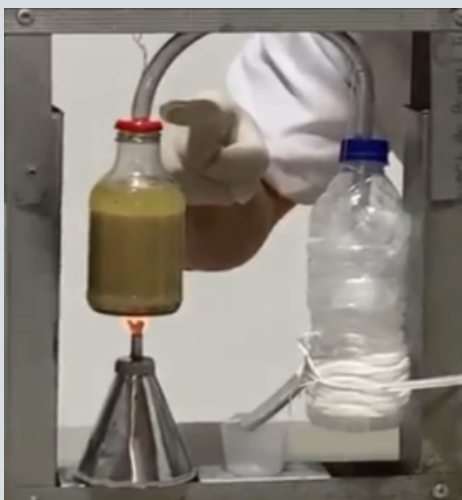
Figura 8 - Esquema representativo do experimento de produção de etanol
