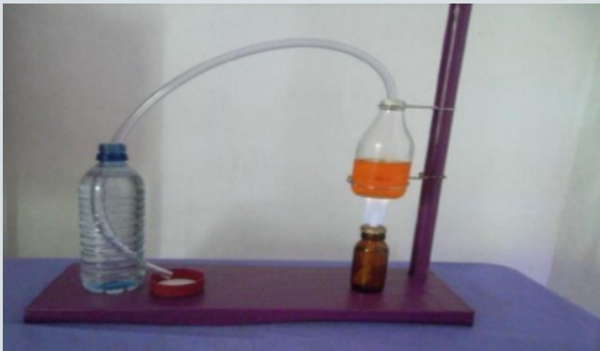
Figura 5 - Esquema representativo do experimento de produção de etanol
