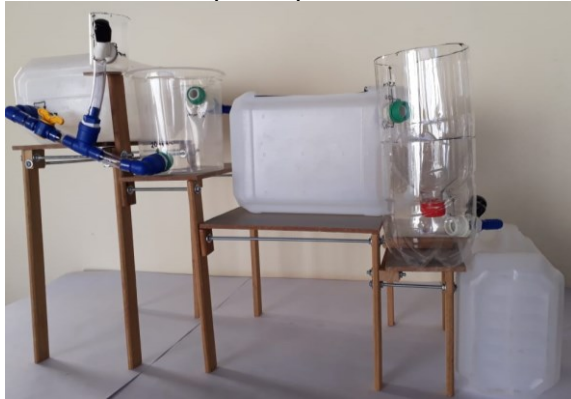
Figura 43: Vista lateral do protótipo funcional da ETA Finalizada.
