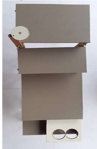
Figura 41: Suporte do protótipo funcional da ETA com as placas de MDF.
