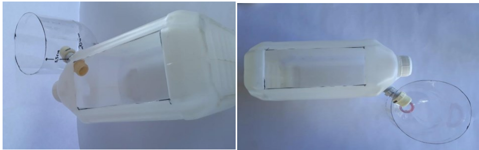
Figura 25: Conexão do galão 2 com a garrafa descartável de 3 litros.
