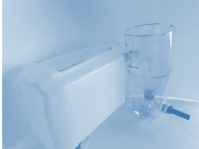
Figura 27: Conexão do galão 2 com a garrafa descartável de três litros.
