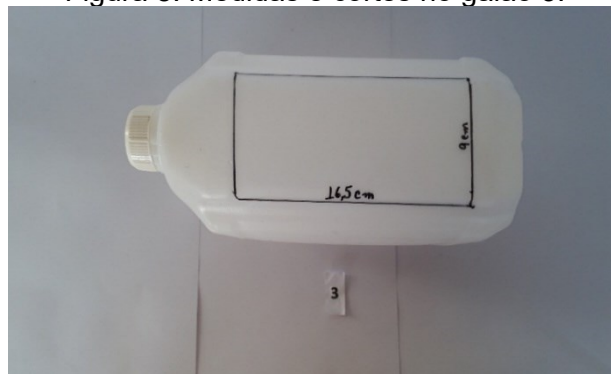
Figura 8: Medidas e cortes no galão 3.
