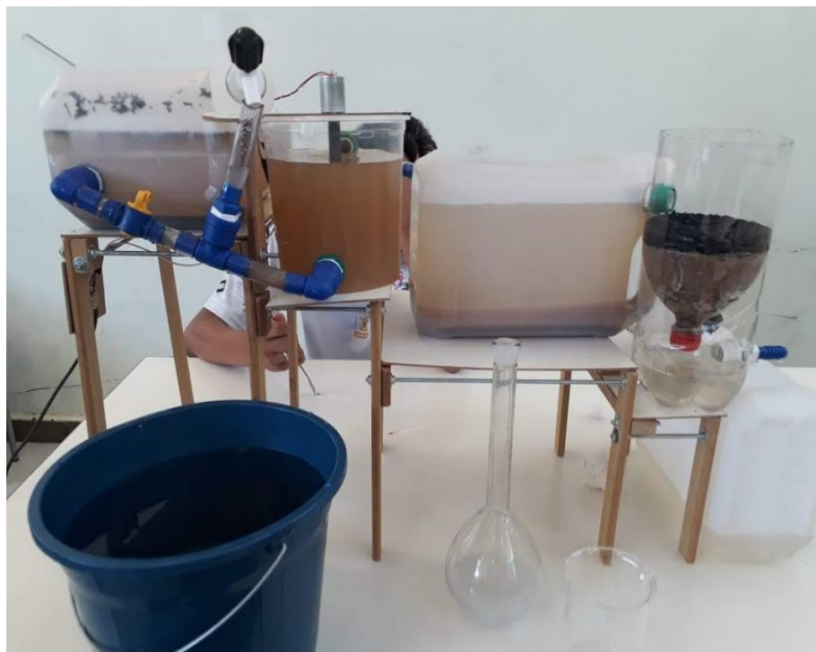
Figura 47: Protótipo da ETA em funcionamento
