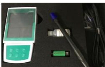
Figura 6: Instrumento portátil para determinação de temperatura e quantidade de oxigênio dissolvido na água. Fonte: O autor 2019
