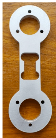
Figura 5: Célula de Carga Fabricada
