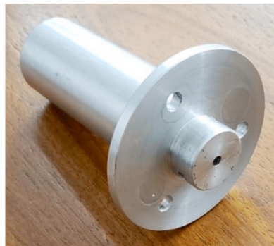
Figura 13: Cubo de Roda Fabricado.
