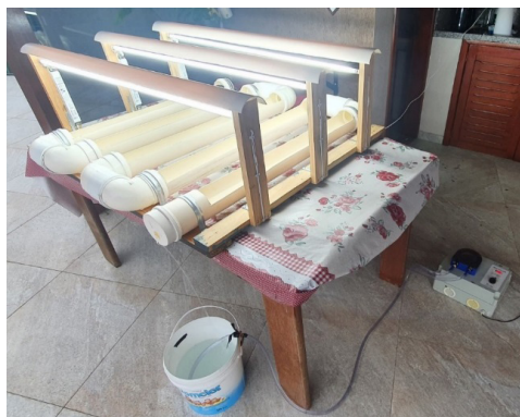
Figura 1 – Sistema de POAs (UV/ H_2O_2 ) montado e em funcionamento
