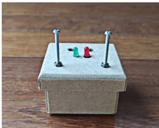
Figura 02: O Coulomboscópio de baixo custo.
