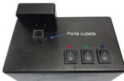
Figura 16. Vista frontal do fotômetro proposto.
