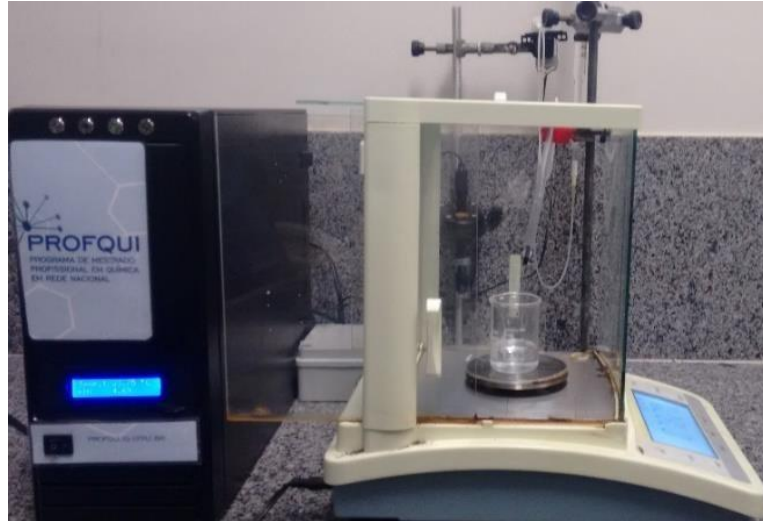
Figura 60. Sistema para medida de vazão da válvula peristáltica
