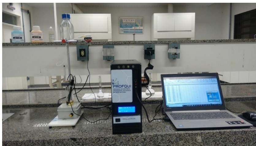
Figura 57. Sistema proposto de titulação potenciométrica automatizada.
