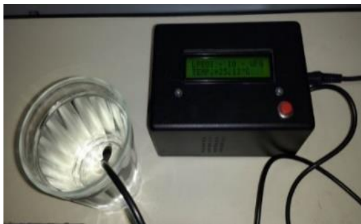
Figura 34. Termômetro vocalizado de laboratório adaptado para DV.
