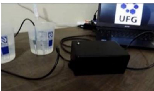
Figura 33. Termômetro vocalizado de laboratório adaptado para DV.
