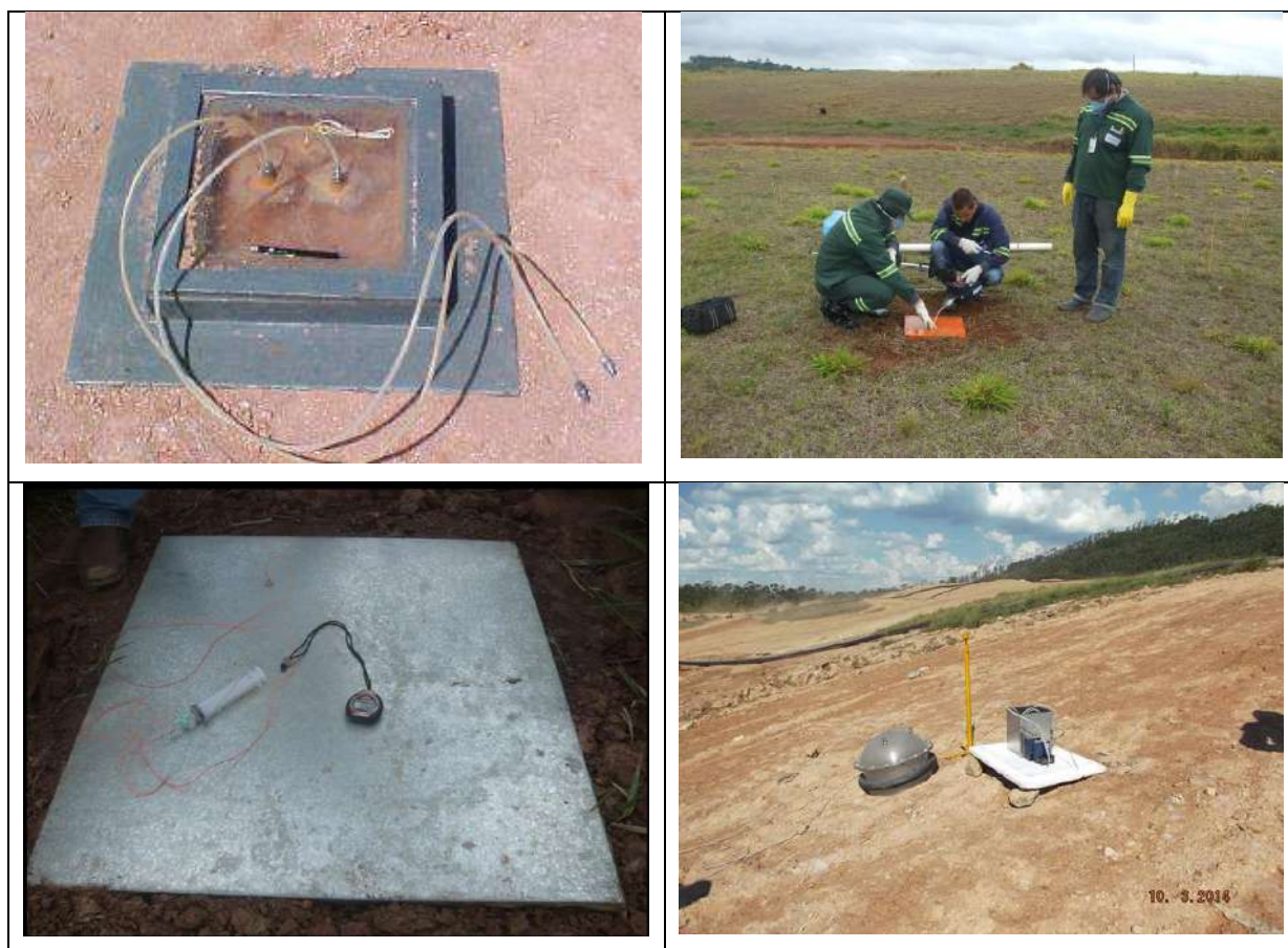
Figura 17 – Principais tipos de placas de fluxo para medir o escape fugitivo de metano em aterro sanitário. Fonte: Elaborado pelo autor (2020).
