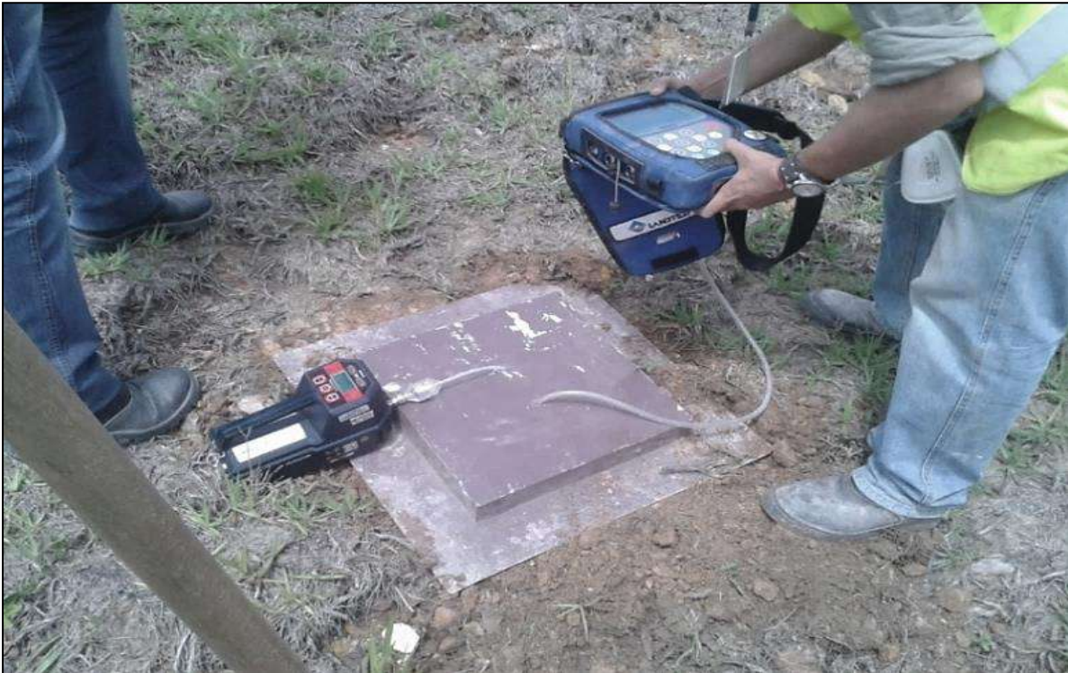
Figura 24 – Medição do escape fugitivo de gás metano por meio de placa de fluxo no Aterro Sanitário Caieiras. Fonte: Acervo pessoal do autor.
