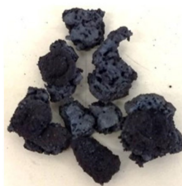
Figura 9: Partes fraturadas de pelotas com 9% de CaO, 12% de carvão ativado, 1160°C, 10min.
