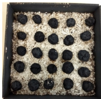
Figura 2: Pelotas com 12% de cal queimadas a 1160°C por 30min.
