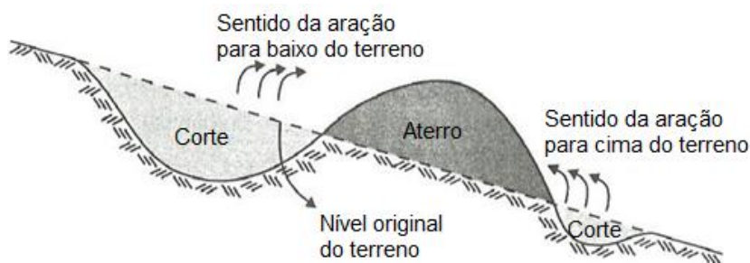
Figura 10. Processo de construção do terraço tipo Mangum.
