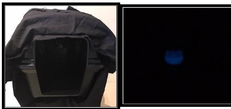
Figura 5 – Parte frontal da câmara de revelação de quimioluminescência e visualização da reação de fluorescência dentro da câmara de revelação.
