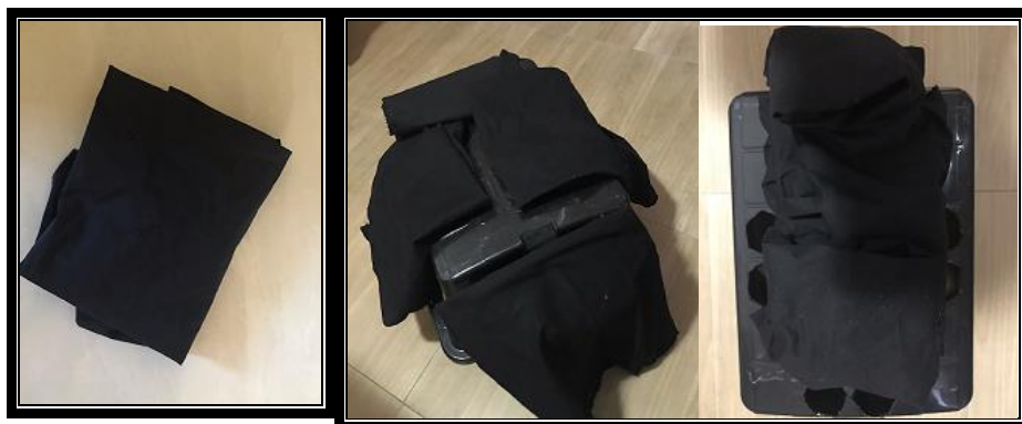
Figura 4 – Tecido de brim na cor preta e posicionamento dos tecidos no preparo da câmara escura.
