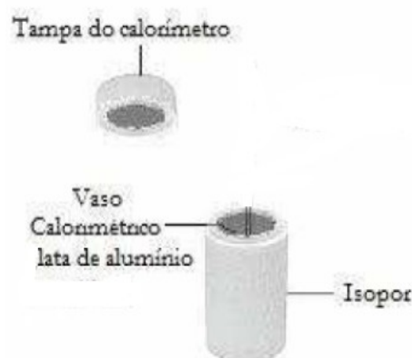
Figura 20- Esquema de montagem do calorímetro.
