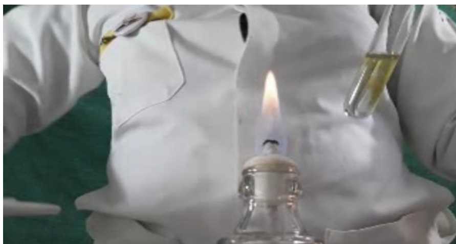
Figura 26 – Início da formação das nanopartículas de prata.
