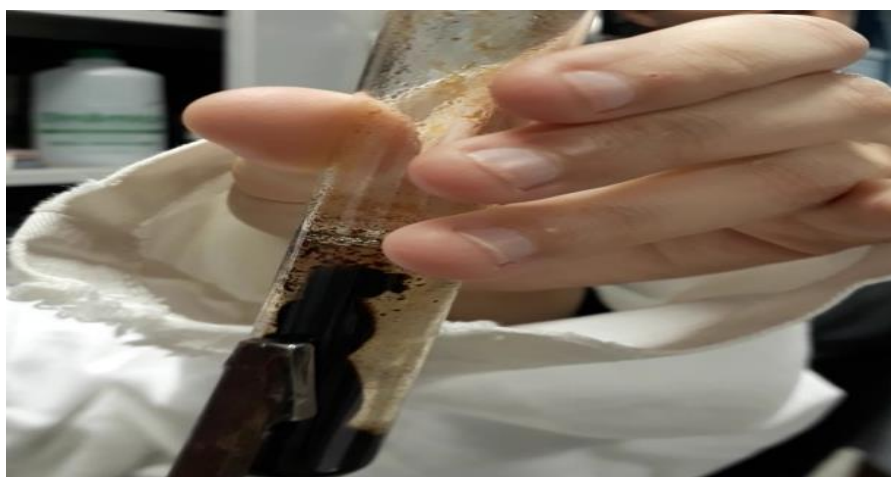
Figura 31 - Experimento formação de nanopartículas paramagnéticas de óxido de ferro ( \text{Fe}_3\text{O}_4 )
