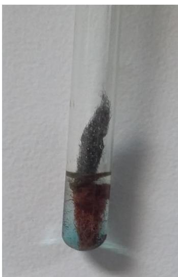
Reação entre ferro e sulfato de cobre II, formando cobre metálico.
