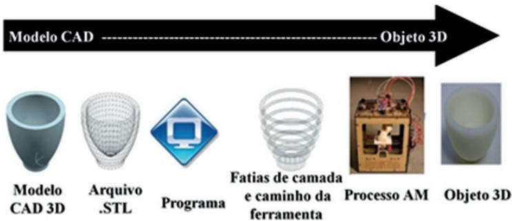
Figura 2 - Processo de Fabricação Aditiva Generalizado
