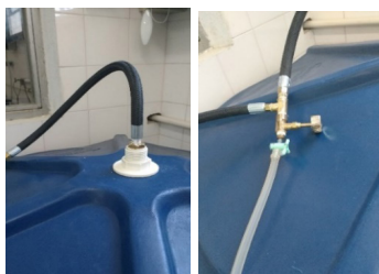
Figura 5 – Conexão do sistema de coleta do biogás à caixa d'água (esquerda) e saída adaptada para a coleta de gases antes de passar pelo filtro de carvão ativado (direita).
