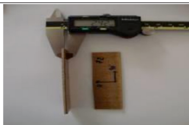
Figura 2- Amostras dos laminados PEI/fibra de vidro dimensionadas para o ensaio Lap Shear .
