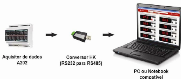
Figura 2. Conversor e aquisitor de dados A202
