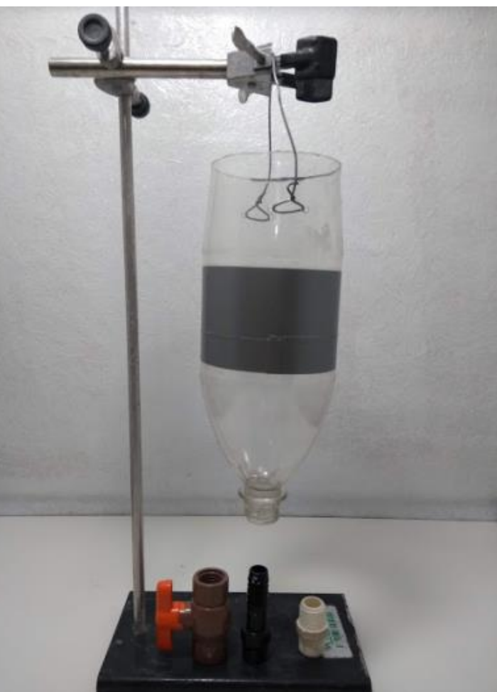
Figura 13: Funil de decantação adaptado.
