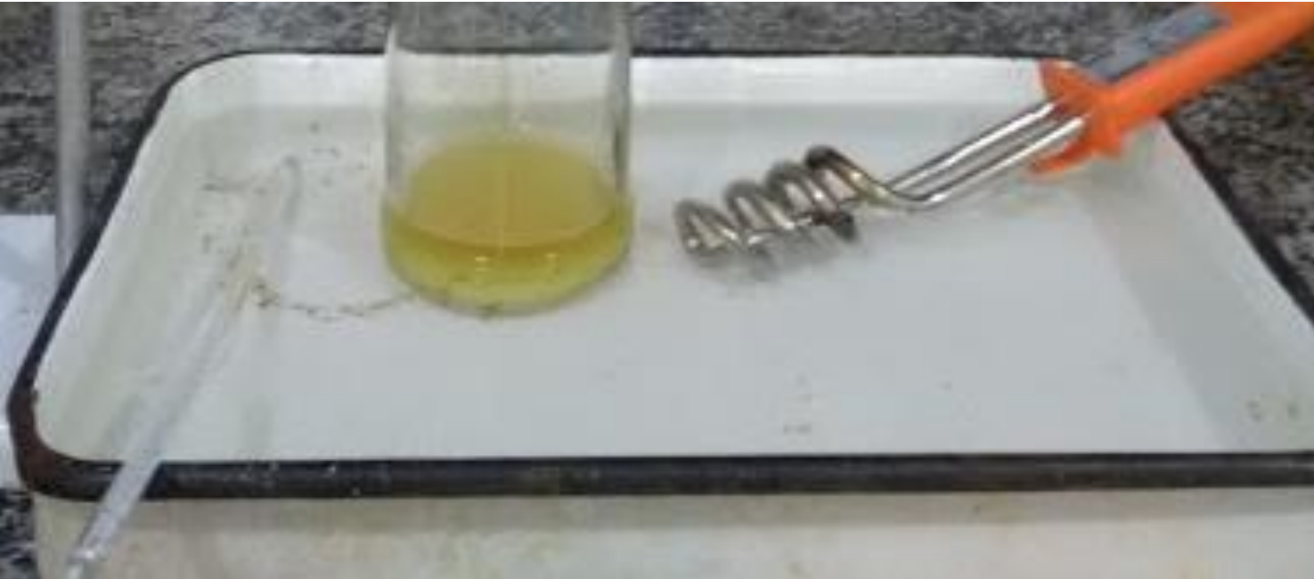
Figura 10: Aquecedor elétrico utilizado para a manutenção da temperatura do meio reacional.
