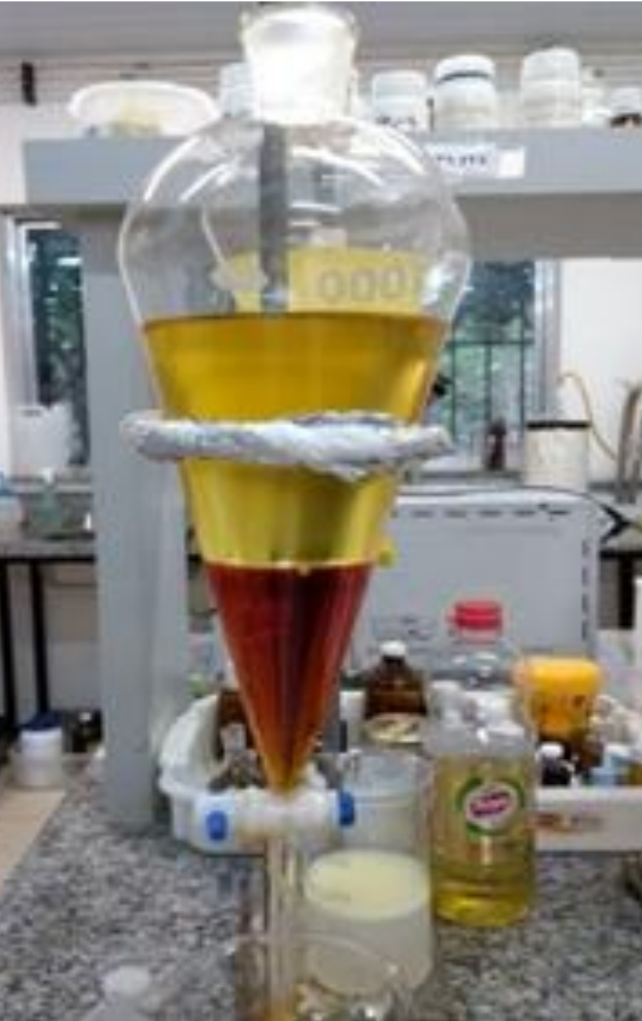
Figura 2: Meio reacional do biodiesel metílico após 24 horas de repouso.
