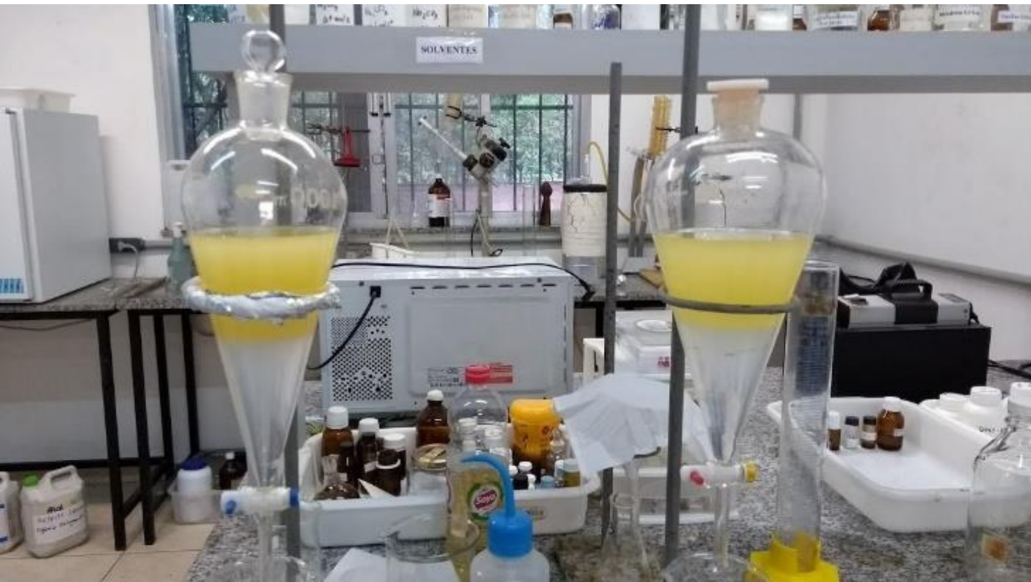
Figura 3: Etapa de lavagem do biodiesel.
