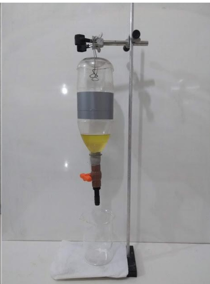
Figura 13: Funil de decantação adaptado.
