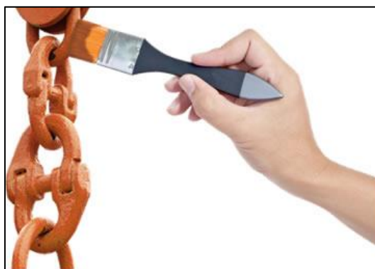
Figura 45: A utilização do zarcão para a proteção de superfícies contra a corrosão. Fonte: https://mundoeducacao.bol.uol.com.br/quimica/protecao-dos-metais-contra-corrosao.htm , acessado em 30 de julho de 2019.
