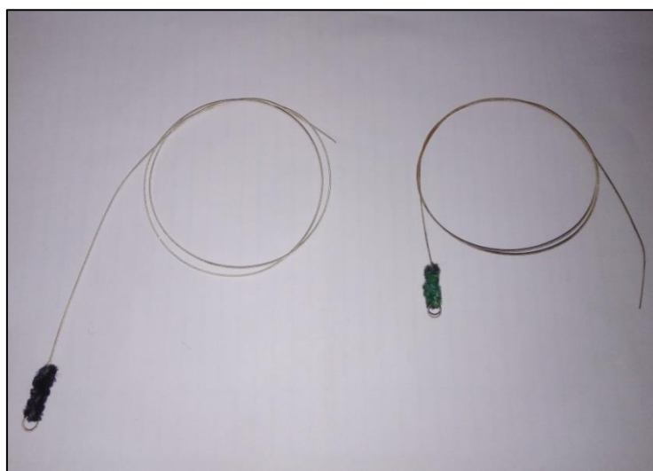
Figura 60: As cordas do cavaquinho após o procedimento experimental. A corda da esquerda, colocada em um frasco com água e, a da direita acondicionada em um frasco com suco de limão e água oxigenada. Fonte: Próprio autor.
