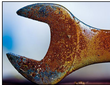
Figura 39: Ferramenta atingida pela corrosão eletroquímica. Fonte: https://betaeq.com.br/index.php/2018/11/27/os-tipos-de-corrosao/ , acessado em 05 de julho de 2019.
