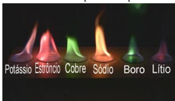
Figura 6 - Cores das chamas produzidas por diversos sais
