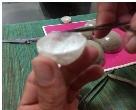
Figura 9: acabamento dos hemisférios
