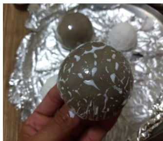
Figura 6: distribuição de cola na superfície do molde
