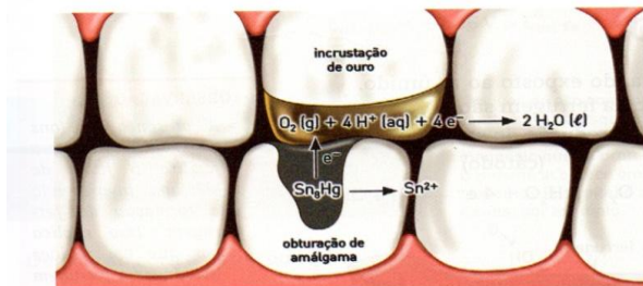
Corrosão de uma obturação pelo contato com o ouro.
