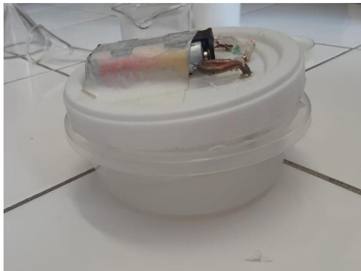
Condutivímetro elaborado utilizando um pote plástico, suporte para pilhas AA, dois pedaços de cobre e cola quente.
