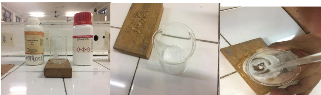
Imagem 3: Reação com reagentes sólidos: cloreto de amônio com hidróxido de bário octahidratado Fonte: própria do autor.
