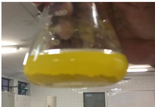
Imagem 4: Formação do precipitado de iodeto de chumbo (II) Fonte: própria do autor.
