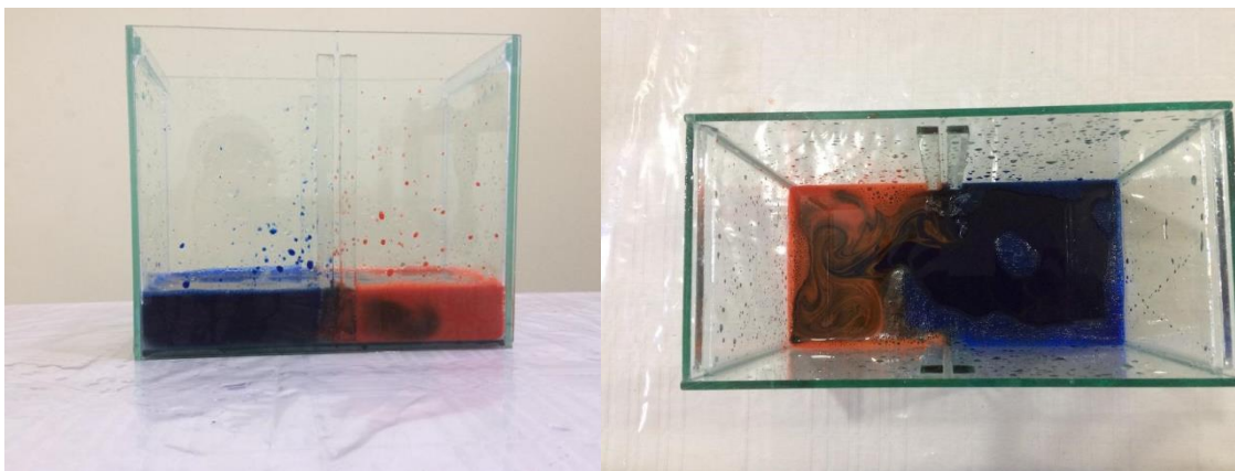
Imagem2: mistura contendo água, líquido quente (laranja) e frio (em azul) se misturando. Fonte: própria do autor.
