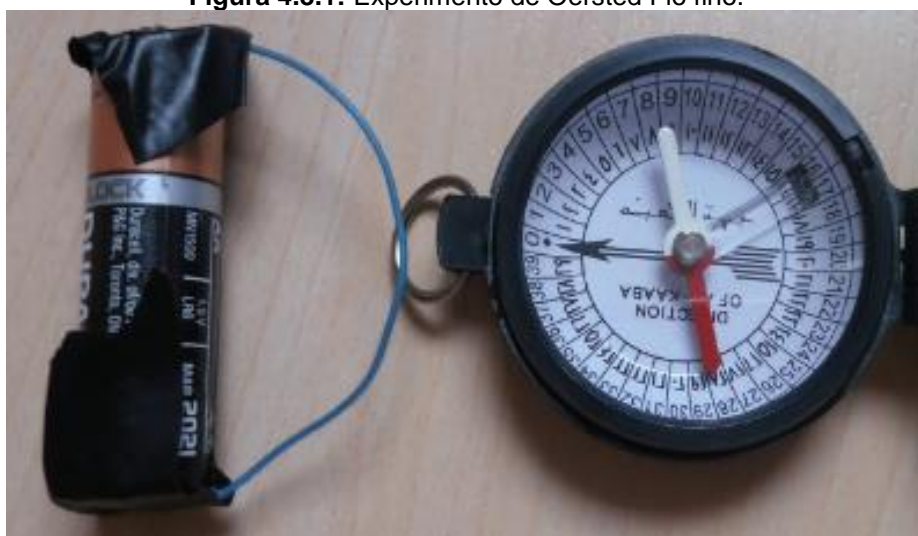
Figura 4.8.1: Experimento de Oersted Fio fino.
