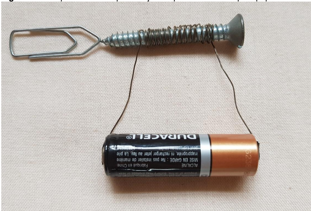
Figura 4.10: Experimento da aproximação do parafuso a um clipe de papel
