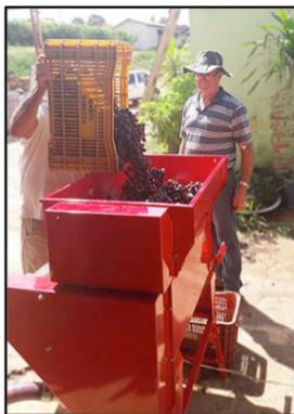
Foto 1. Equipamento para esmagamento da uva – desengaçadeira.
