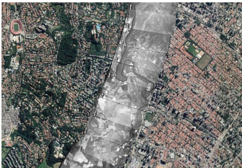
Figura 4: Em tons de cinza as imagens do levantamento aerofotogramétrico realizado em 1933 que recobre a calha do Rio Pinheiros. O fotoíndice após o georreferenciamento pode ser sobreposto a bases cartográficas atuais (imagem colorida), viabilizando a análise das mudanças no uso e ocupação do solo na região.
