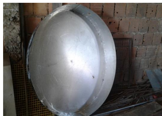
Figura 2. Tanque sendo confeccionado, parte interna.
