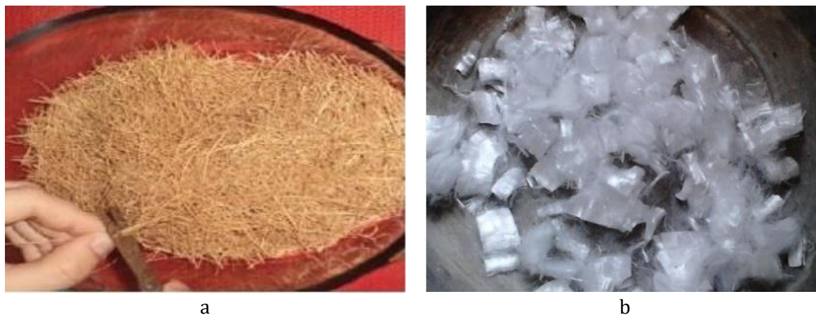
Figura 2. Fibras utilizadas na pesquisa. a) fibras de coco; b) fibras de polipropileno.
