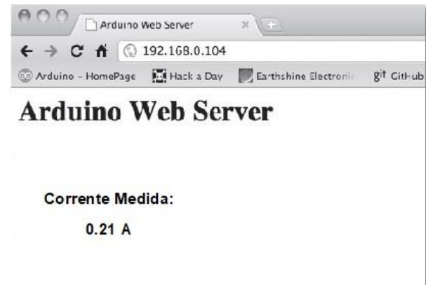
Figura 14. Supervisão remota da corrente gerada.
